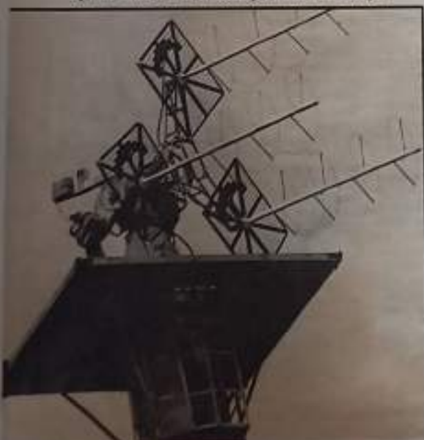
System anten do odbioru informacji z satelitów badawczych
